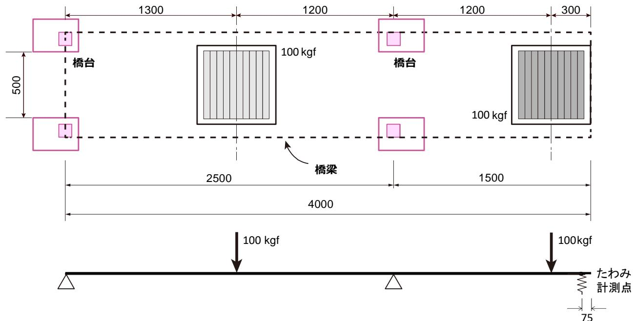
図-3.3 載荷場所とたわみ計測位置
