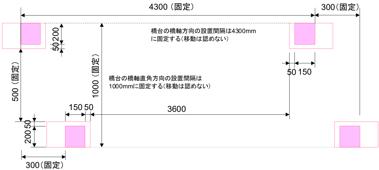
図-2.2 橋台の設置位置および橋梁の設置位置 (単位 : mm)
