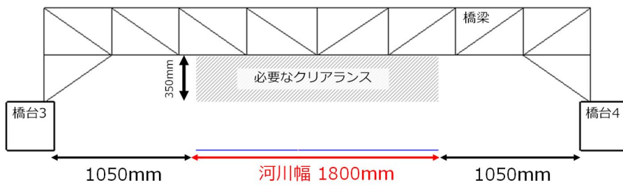
(b) 河川上のクリアランス(上：鳥瞰図，下：側面図)
